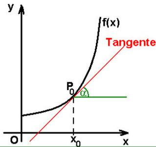
Der Steigungswinkel  $\alpha$  gibt die Steigung eines Funktionsgraphen an einer Stelle  $x_0$  an.
