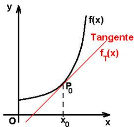
Gerade  $f_T(x) = m \cdot x + n$  ist Tangente an den Graphen der Funktion  $f(x)$  im Punkt  $P_0$
